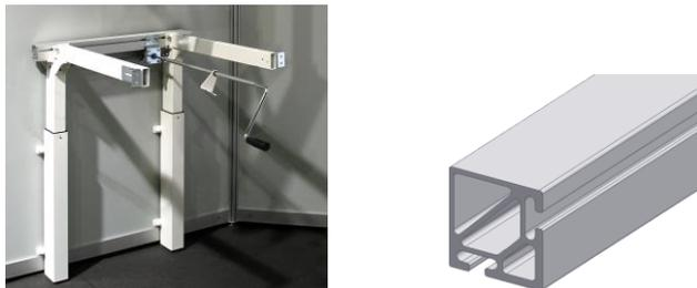
Die patentierte Architektur des 5cm x 5cm Aluminium-Profils ermöglicht ein Auflagegewicht von 150kg bei gleichzeitig geringsten Abmessungen. Dadurch können Spülen und Kochfelder in Standardarbeitsflächen mit 60cm Tiefe verbaut werden. Und, vielleicht noch wichtiger: Extrem flache Arbeitsplatten-Aufbauten (ab 5,6cm) ermöglichen so das tiefere Herabsenken auf eine wirklich ergonomische Arbeitshöhe im Sitzen.
